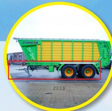
Fahrgestell, Aufbau und Bodenbleche sind verzinkt um eine lange Lebensdauer zu gewährleisten
